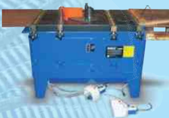
ohýbání betonářské oceli do průměru 32mm na stroji STEMA SPECIAL 42S
