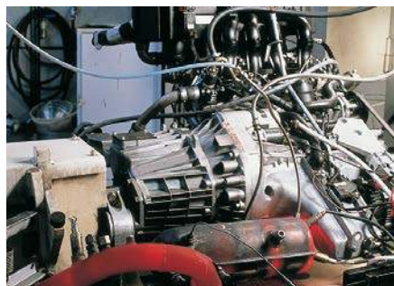
Zkušebna spalovacích motorů V automobilovém průmyslu měří senzory na bázi vířivých proudů za nepříznivých podmínek v běžícím spalovacím motoru.
