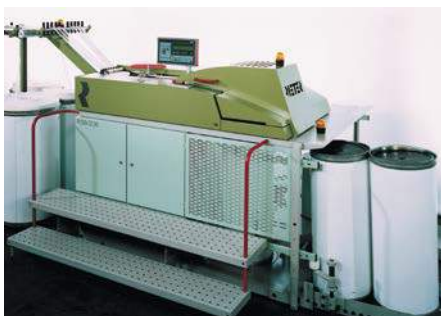
Příklady použití: kontrola práce stroje Senzory na bázi vířivých proudů kontrolují kolísání tloušťky příze v textilních strojích.
