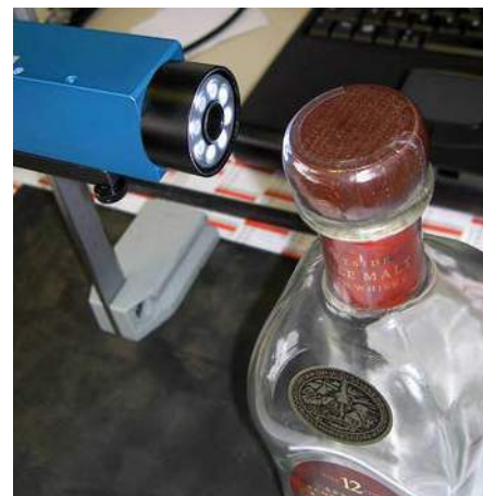
Kontrola obalu výrobku v průběhu produkčního procesu.
