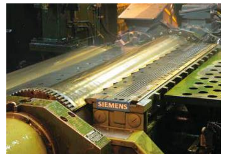
Zajišťování jakosti Senzory na bázi vířivých proudů měří rovinnost ocelových plechů pro kontinuální monitoring jakosti.
