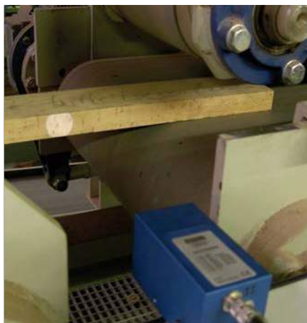
Díky vysoké rychlosti otáčení dřeva ztmavne. Toto je rozpoznáno senzorem barev.
