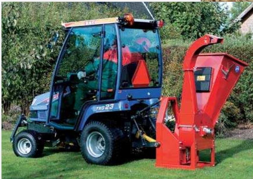
Štěpka vyprodukovaná těmito stroji je velmi homogenní a stává se stále vyhledávanějším produktem, který se využívá na topení, mulčování, ale i k vrstvení na cesty, na kterých není velký provoz. Štěpkovače zpracovávají větve nebo celé stromy pomocí nožů, které jsou umístěny na rotujícím disku. Velikost štěpky činí 5 – 50 mm v závislosti na typu štěpkovače.
